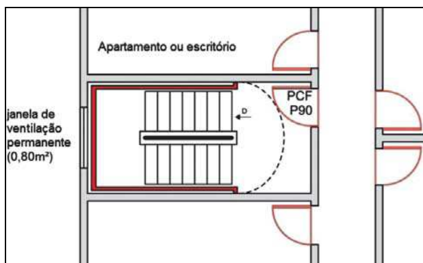
Figura 7: Escada enclausurada protegida
